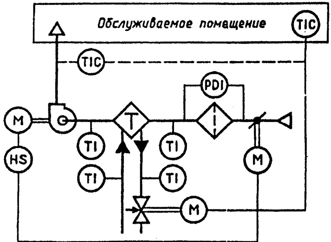
"Пример выполнения принципиальной технологической схемы вентиляционной системы"
