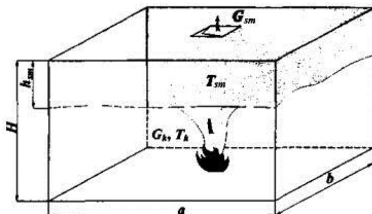
*Рис. 1. Расчетная схема газообмена в горячем помещении, защищаемом вытяжной противодымной вентиляцией*
