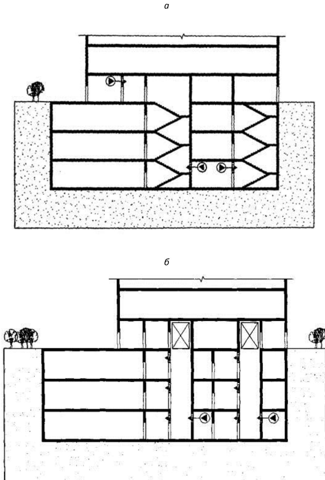
Рис. 5. Схемы подачи воздуха в лестничные клетки (а) и в лифтовые шахты (б) подземной части здания
